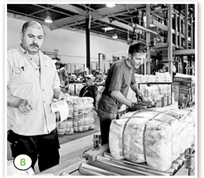
PRESSE: Die Maschine im Hintergrund presst die sortierten Kleider für den Export. Die Ballen werden von Hand kodiert.
